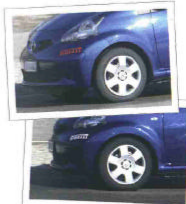
In alto, la Toyota Aygo con i Pirelli Cinturato P4 sgonfi e, qui sopra, l'auto con le stesse gomme a pressione corretta. Si nota bene il differente schiacciamento del pneumatico
